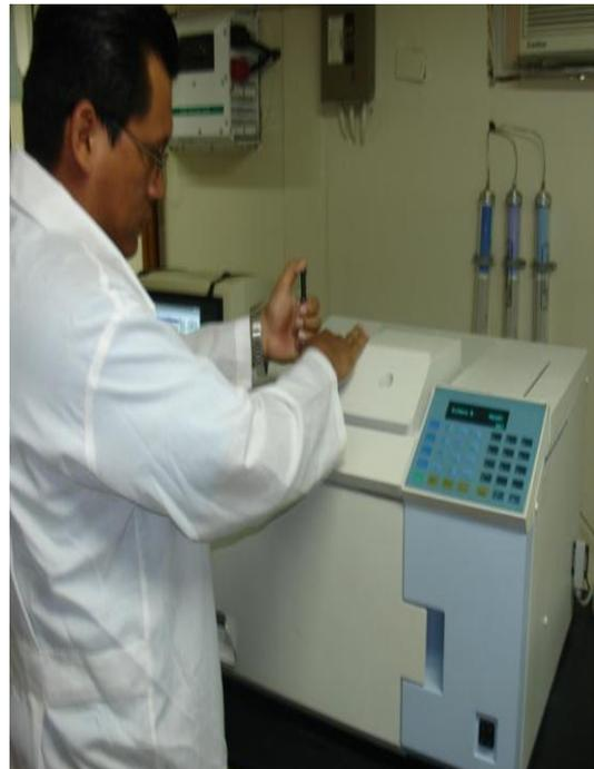
**FOTOGRAFIA 7: INYECCIÓN DE LAS MUESTRAS EN EL CROMATOGRFO DE GAS**
