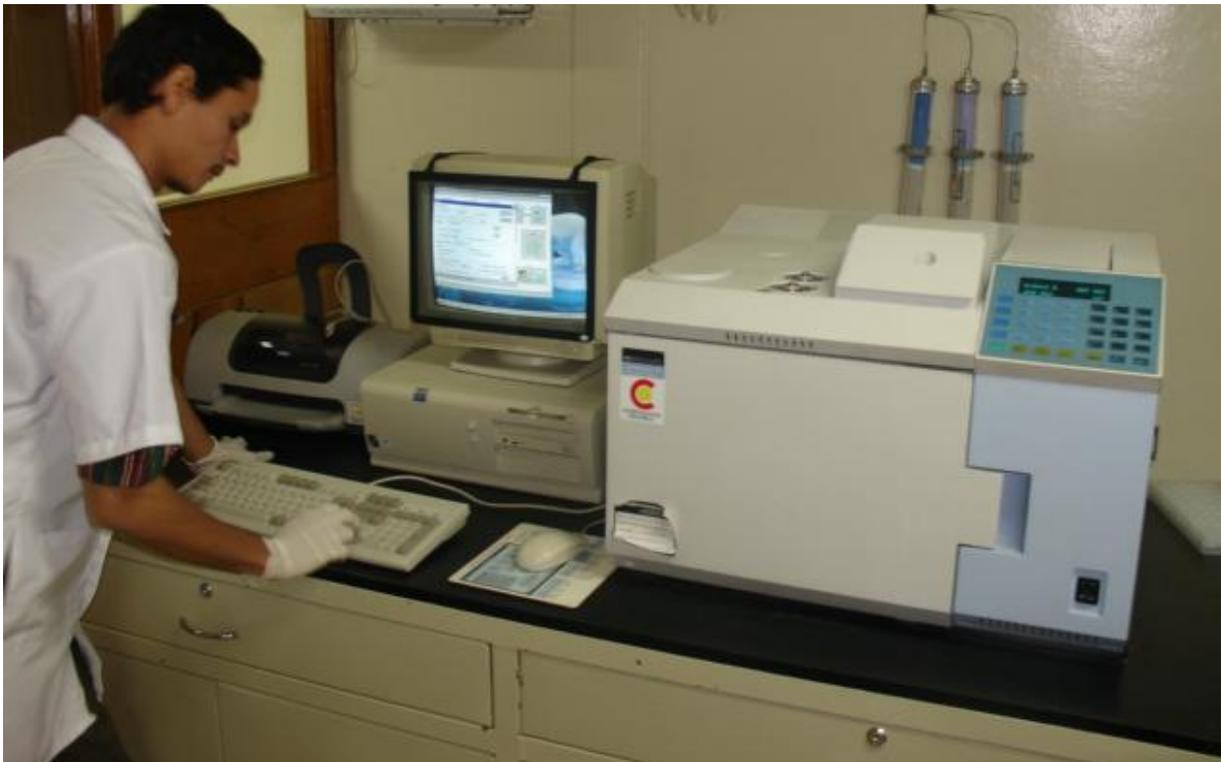
**FOTOGRAFIA 6: PROGRAMACIÓN DEL METODO EN EL CROMATOGRAFO DE GAS.**
